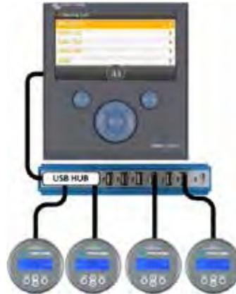
Es können bis zu vier BMVs direkt mit einem Color Control verbunden werden. Es lassen sich sogar noch mehr BMVs an einen USB-Hub anschließen, um zentral überwacht zu werden.
